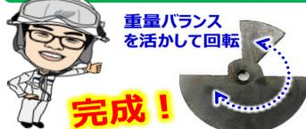
再挑戦で完成した連結のしくみは車のドアロックをヒントに重量バランスを活かした回転式。構成パーツは3種類で当たることでの消耗を考え安易に交換できるようにしました。この改善も連結部には触れることなく作業できるものとなりました。
