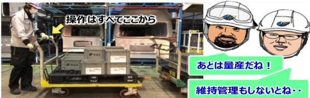
切り離しの改善は台車の取手解除を継続、ワイヤースは廃止し台車下側の連結棒に変更しました。あたりまえだった連結の手作業は「屈まず・歩かず」のワンタッチへと変貌を遂げました。更にトライを重ね量産と維持管理の仕組みを考えることにしました。
